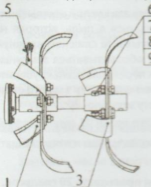
фрезы 1 с отверстием во втулке фрезы 3, вставьте болт 6 и зафиксируйте его гайкой 7 с шайбами 8, 9.
