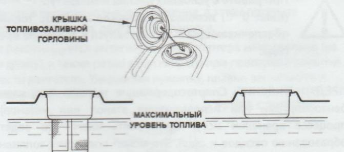
Если топливо пролилось, уберите мотоблок от места разлива топлива. Избегайте источников образования искры, пока пары бензина полностью не выветрятся. Протрите насухо пролитое масло или топливо. Не храните топливо и не заполняйте бензобак вблизи открытого пламени.
