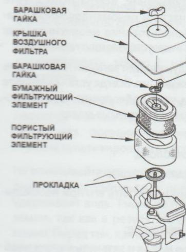
**1.** Отвинтите барабановую гайку, снимите крышку фильтра, пористый и бумажный фильтрующие элементы.
