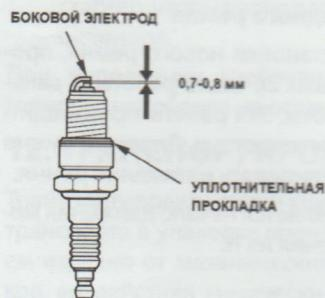
4. Измерьте зазор между электродами свечи при помощи проволочного щупа. При необходимости откорректируйте зазор, осторожно подгибая боковой электрод. Зазор должен быть в пределах: 0,7-0,8 мм.
