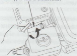
3. Проверьте свечу зажигания. Замените свечу, если она повреждена, если уплотнительная шайба в плохом состоянии или изношена электрод.
