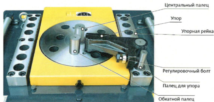
Рис. 4Б Рабочая поверхность GW 40А
