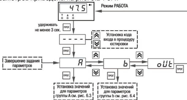
Рис. 6.2. Последовательность работы с прибором на втором уровне программирования
