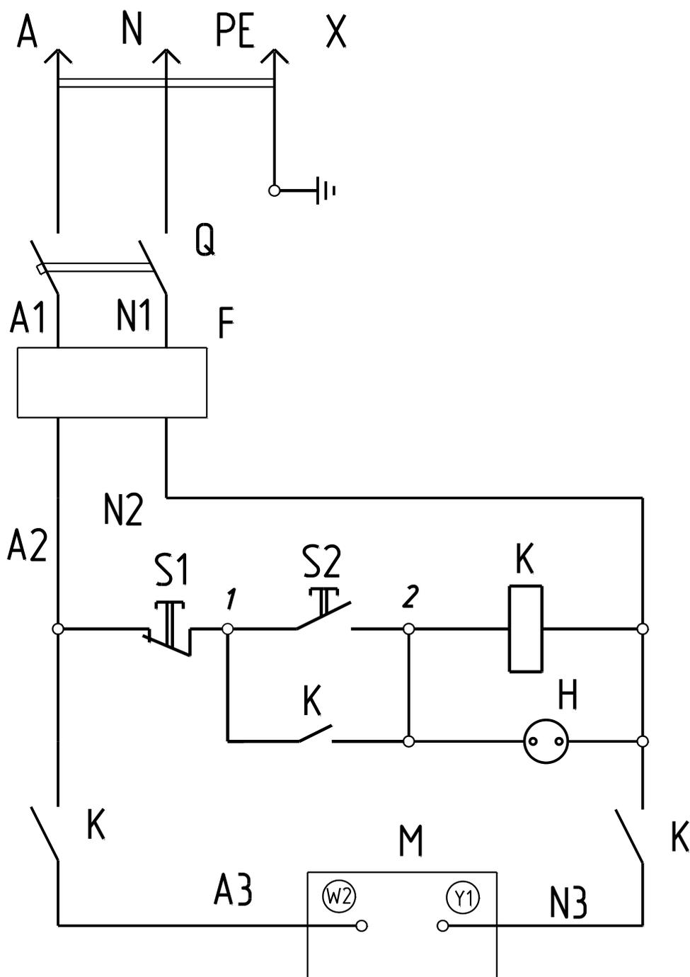
Рисунок 10 - Схема электрическая принципиальная машины СО-206.1А
