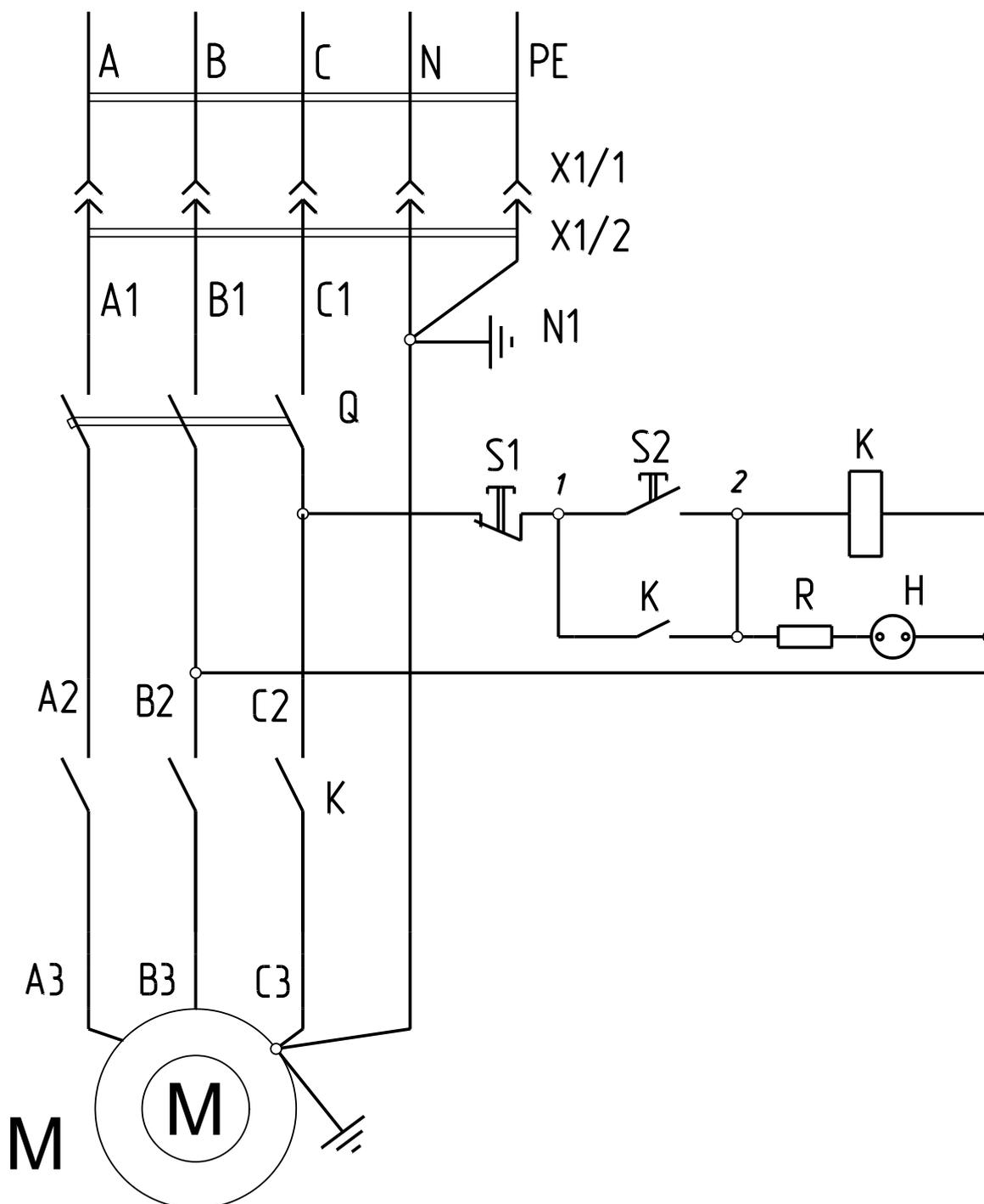
Рисунок 9 - Схема электрическая принципиальная машины СО-206А
