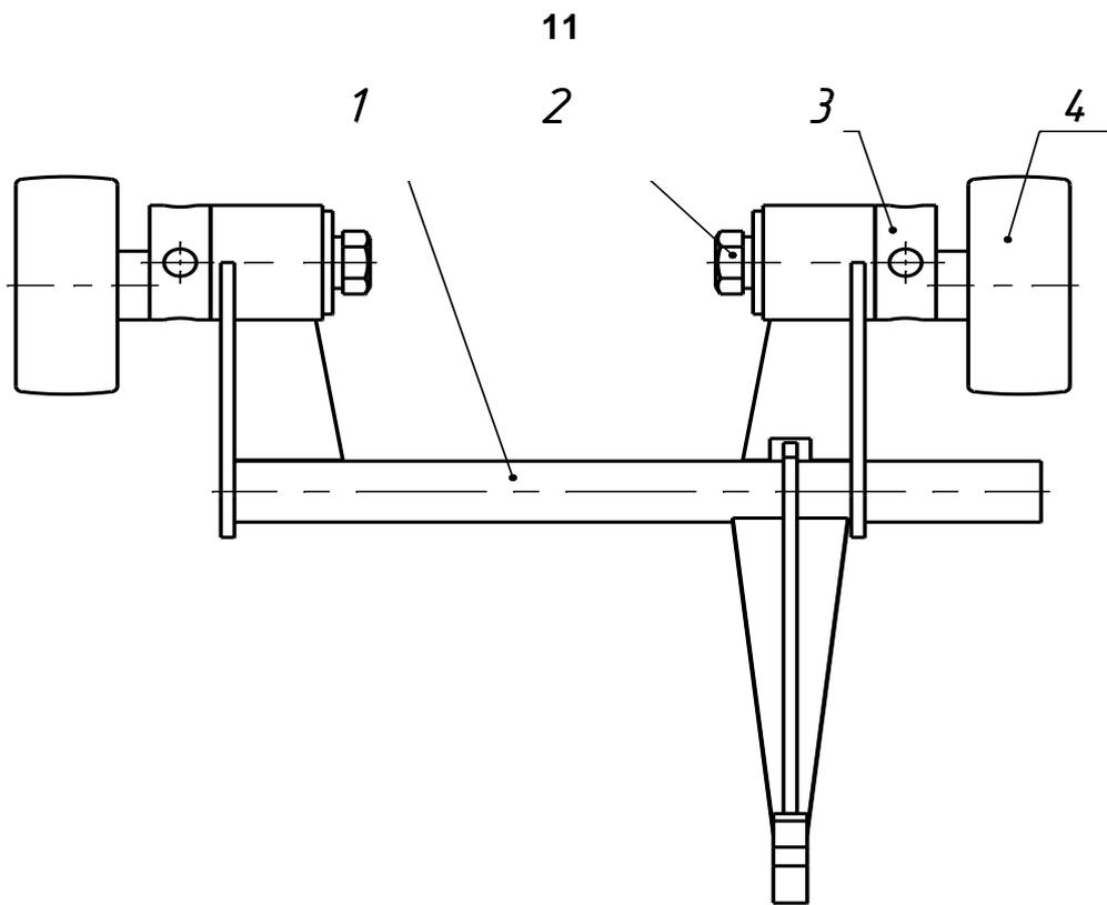
Рисунок 7 - Регулировка положения колес
